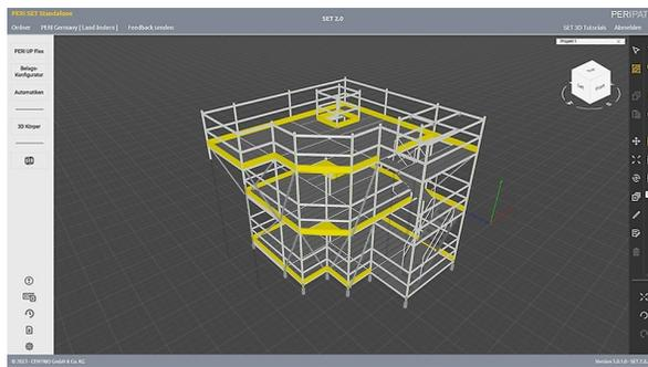
La función automática le ayuda a planificar las necesidades de andamios circulares. Con unos pocos clics, SET organiza automáticamente las unidades de andamio según el radio requerido. Además, se puede visualizar el entorno en el que se planifica el andamio mediante la colocación de cuerpos 3D.
