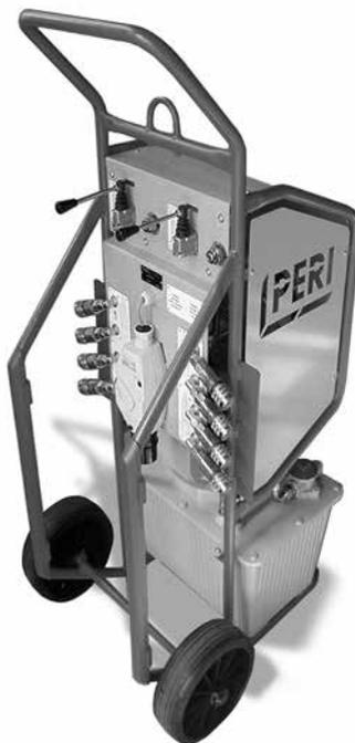
Fig. 18: Unidad hidráulica
