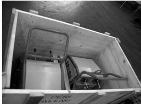
Fig. 17: Caja de transporte para unidades hidráulicas
