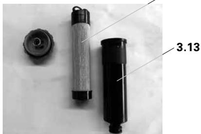
Fig. 25: Desmontar el filtro
