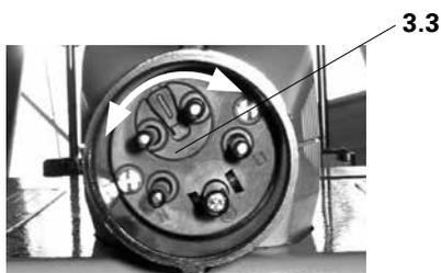
Fig. 39: Toma corriente con inversor de fases
