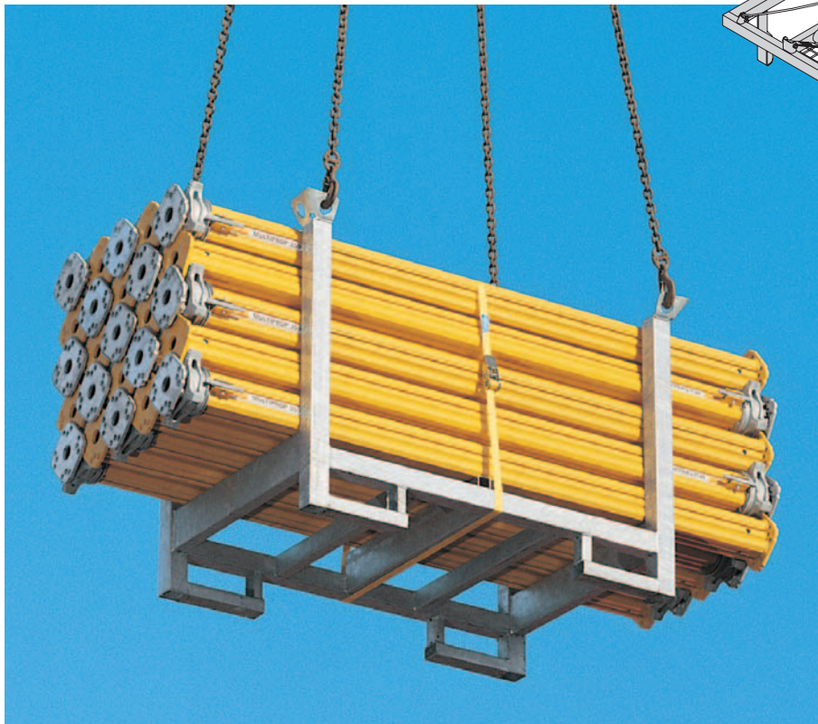
Palet PR 80 x 120, cargado con 25 puntales MULTIPROP, que corresponde a 86 m 2 de superficie de encofrado.
